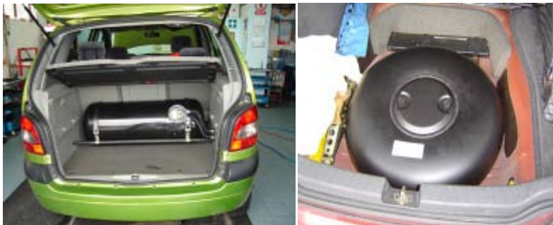
Primjer izvedbe cilindričnog i torusnog spremnika za LPG
