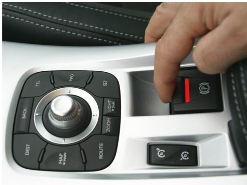
Poluga za električnu aktivaciju i deaktivaciju pomoćne kočnice.
