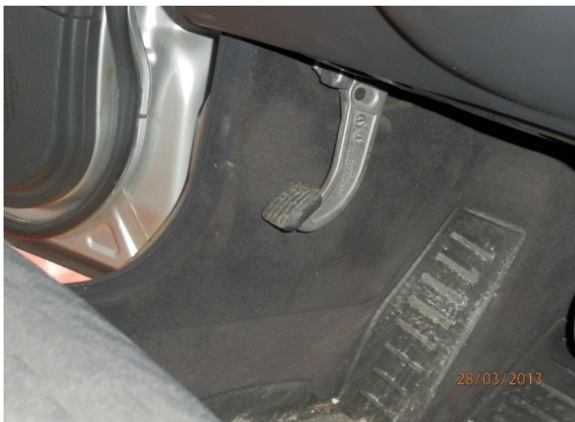
Nožna poluga za aktivaciju pomoćne kočnice
